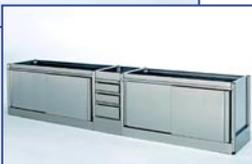
La struttura dei retro banchi magnum può essere completata con top superiore di varia natura. Il tipo da noi proposto è in acciaio inox AISI 304 satinato scotch-brite di spessore 1,0 rinforzato internamente con pannello in legno e con bordo perimetrale inferiore nervato anti goccia. Offriamo inoltre una vasta gamma di ceppi in legno di acacia ed in polietilene per uso alimentare.
