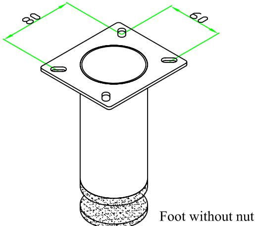
**BendoniInox** Tube Ø60,3 - Normal module type plate (single leg)
