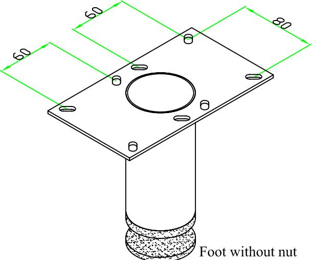
**BendoniInox** Tube Ø60,3 - Double module type plate (double leg)
