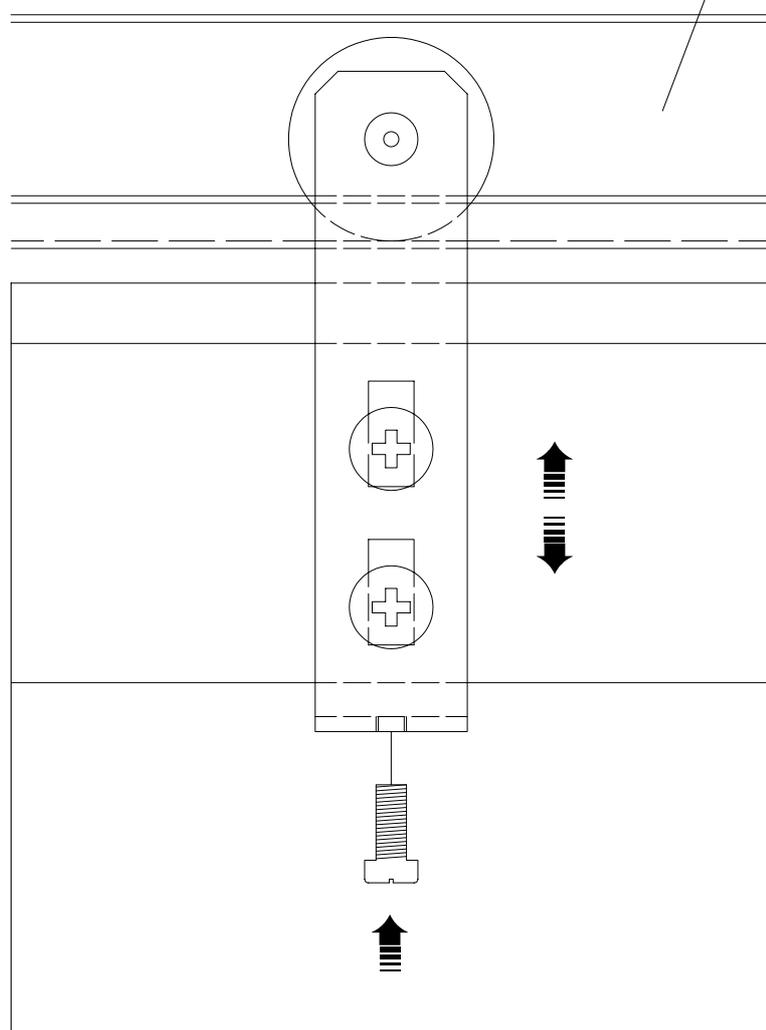
L'aria tra anta e guida può oscillare tra un minimo di 1 ed un massimo di 3 mm
